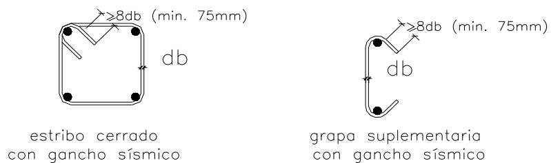
Fig. 21.1d Ganchos sísmicos en estribos y grapas suplementarias
